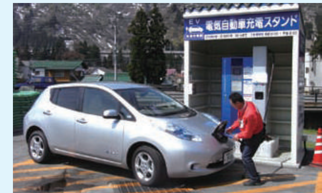
駐車場の一角に設置された急速充電器。
